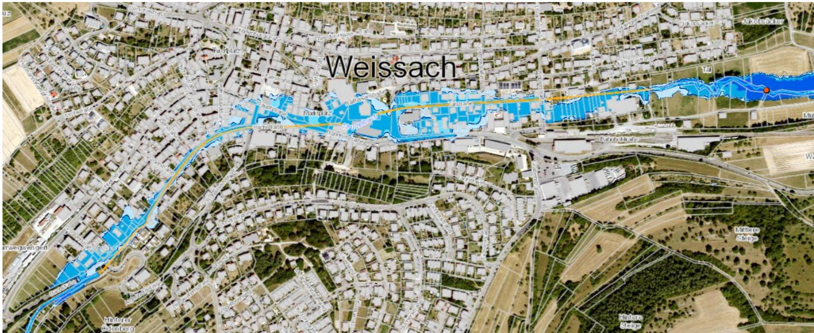
Der 10-jährliche Hochwasserabfluss sowie der 50- und 100-jährlicher Hochwasserabfluss unter Berücksichtigung des geplanten Hochwasserrückhaltebeckens sind über die bestehende Strudelbachverdolung ableitbar.
